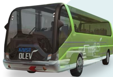
85KHz 활용 전기버스 무선충전 서비스(와이파워원)
